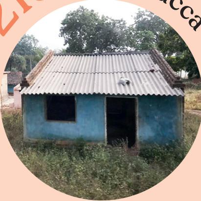
Semi-Pucca-Häuser ähneln den Kutcha-Häusern im Innenbereich, sind aber etwas robuster gebaut. Die Wände bestehen aus Zement oder verputzten Lehmziegeln. Die Dächer sind aus Zement oder Wellblech.
